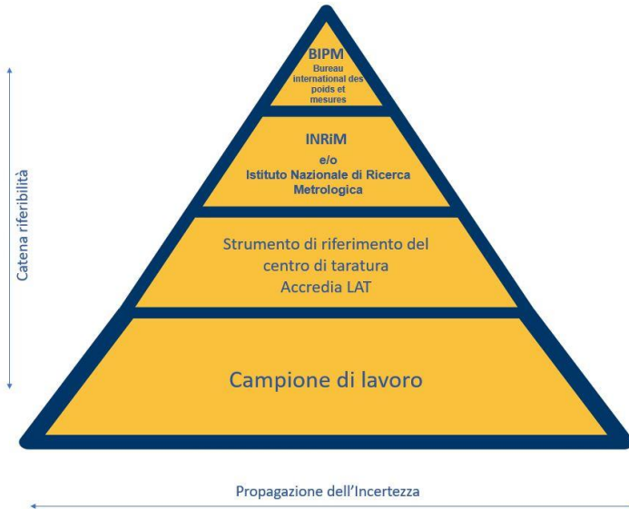
Figura 6.2: Catena di riferibilità vs propagazione dell'incertezza.
