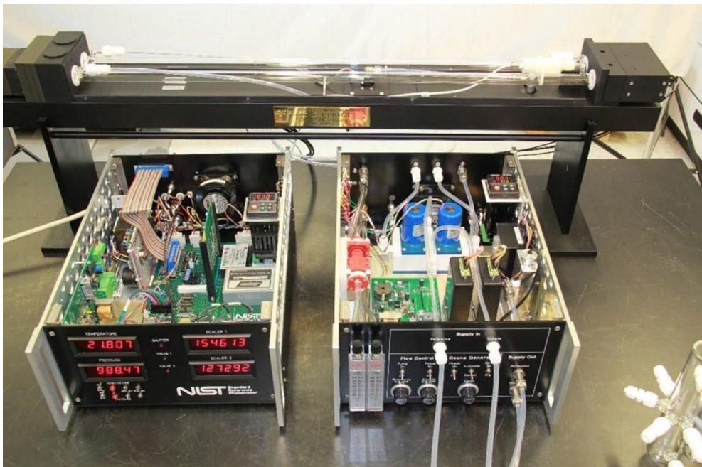
Figura 6.3: Fotometro Standard primario per la misura di ozono.
